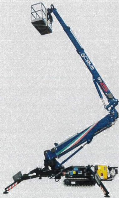
スタビライザー先端にアタッチメントを装着し、自力で4トン平トラックへ搭載可
